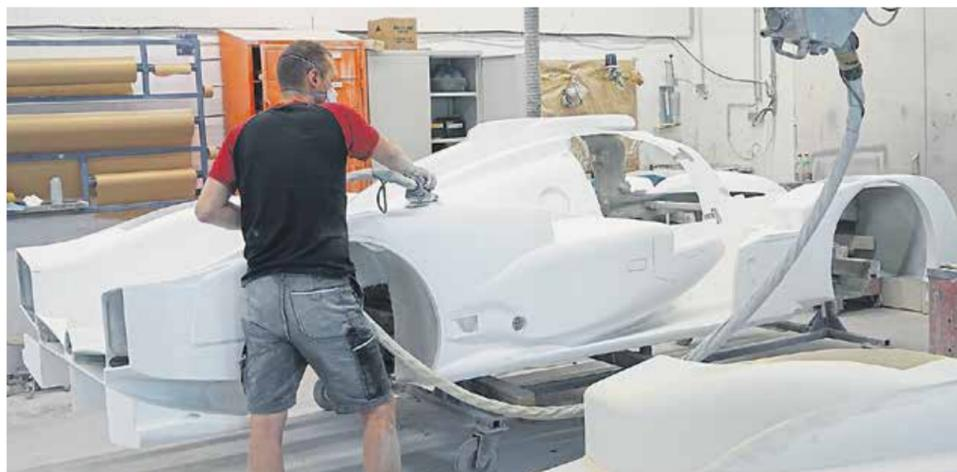
Viele Arbeitsschritte: Nachdem auf einer Portalfräse aus einem Ureol-Block das Urmodell gefertigt wurde, entsteht daraus ein Negativ als Vorlage für die Karosserie, die die Mitarbeiter bei Sonnleitner aus Polyesterharz und Glasfaserplatten formen. Anschließend wird gespachtelt, geschliffen, lackiert und poliert. Foto: Ulrich Steudel
